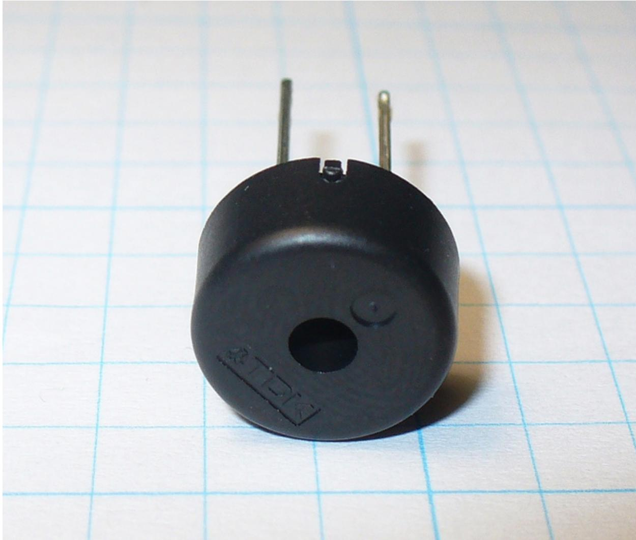
To małe urządzenie wydaje wysoki dźwięk, kiedy zostanie podłączone do obwodu. Aby podłączyć je do swojego micro:bita, możesz przypiąć krokodylki do pinu 0 oraz GND (jak widać na poniższym obrazku).
